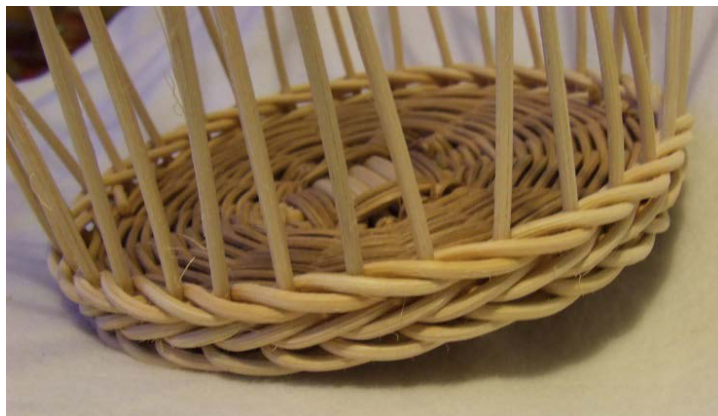
Obrázok 134 Upletenie dvoch vrstiev rýmovky (Zdroj: autor)
