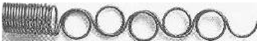
Obrázok 30 Pružina rozložená do pásu kruhových očiek (Zdroj: Hallonová, Krajčová, 2003)
