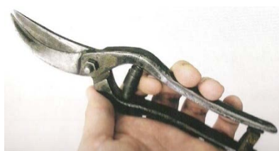
Obrázok 79 Nožnice na prácu s pedigom a prútím (Zdroj: Šebo)
