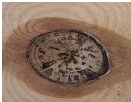
Obrázok 145 Chyby dreva – hniloba, hrče (Zdroj: http://www.rezbarstvo.sk/ )
