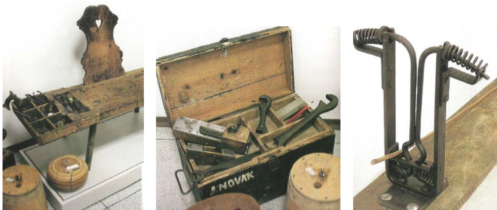
Obrázok 81 Pracovný stolec a náradie košíkára, hoblík, úžidlo, lúpačka, ubíjacie železá, formy na pletenie (Zdroj: Juriga, 2007)
