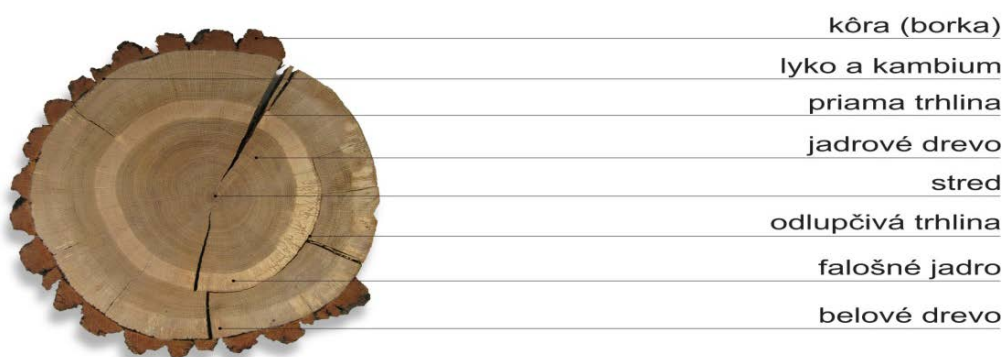
Obrázok 144 Priečny rez kmeňom duba http://www.rezbarstvo.sk/index.php?option=com_content&view=article&id=126:stavbadreva&catid=28:materialy&Itemid=51
