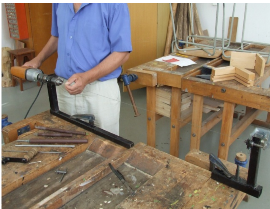
Obrázok 2 Prípravok na namotávanie struniek veľmi malých priemerov 0,8 mm (zdroj: autor)
