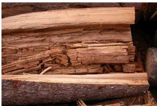
Obrázok 145 Chyby dreva – hniloba, hrče (Zdroj: http://www.rezbarstvo.sk/ )
