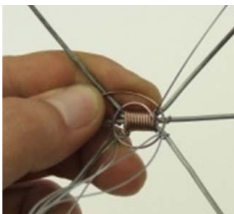
Obrázok 68 Fixovanie kostrových drôtov a začiatok špirálového výpletu (Zdroj: Šebo)
