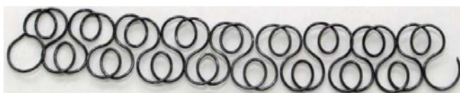
Obrázok 36 Pružina rozložená do pásu srdiečkového vzoru (Zdroj: Šebo)
