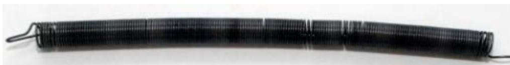
Obrázok 29 Drôt namotaný do pružiny (Zdroj: Šebo)
