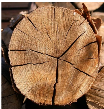
Obrázok 147 Výsušné trhliny v dreve (Zdroj: http://fld.czu.cz/~zeidler/lexikon_vad/ )
