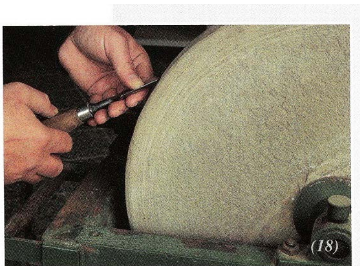
Obrázok 159 Brúsenie dlát na pomalobežnej kotúčovej brúske (Zdroj: Baláž, 2001)
