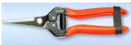
Obrázok 79 Nožnice na prácu s pedigom a prútím (Zdroj: Šebo)
