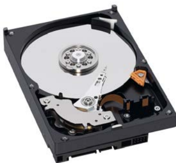
Obrázok 24 Princíp pevného disku (Zdroj: http://www.storagereview.com/seagate_enterprise_value_hdd_constellation_cs_review )
